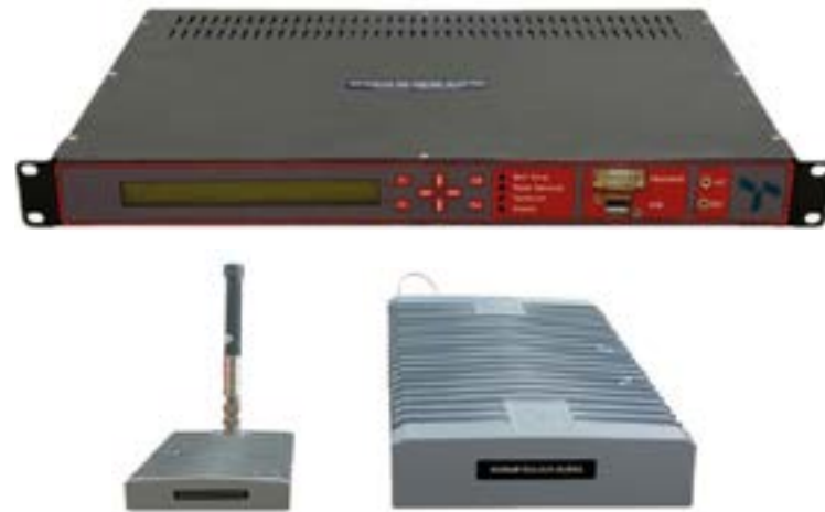
Projede Geliştirilmiş Modülatör, Demodülatör, Entegre Modem ve Navigasyon Radyo İstasyonu
