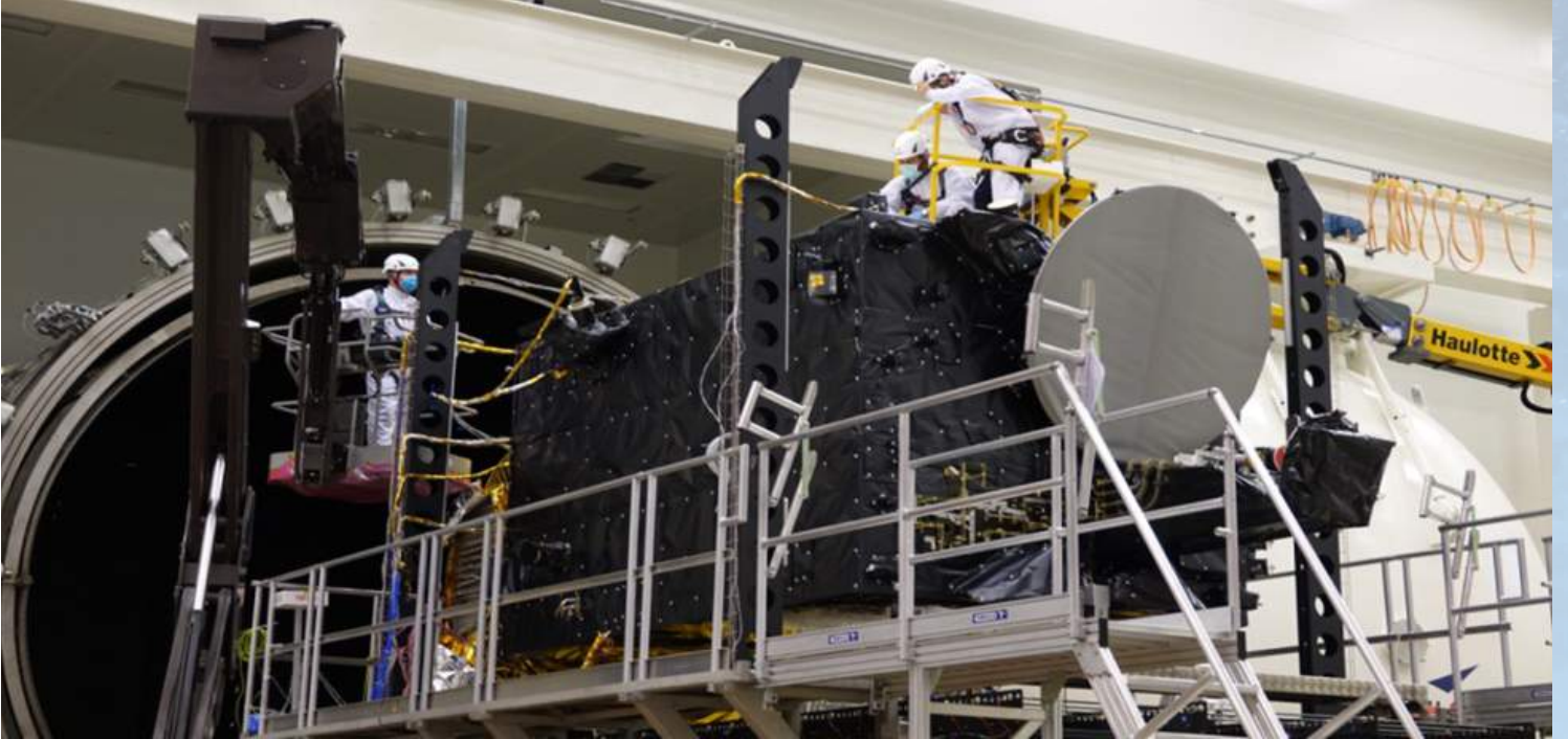
Türksat 6A Uydusu Mühendislik Modeli Isıl Vakum Testi Hazırlıkları
